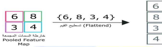
الشكل (3): يوضح آلية عمل طبقة التسطيح
