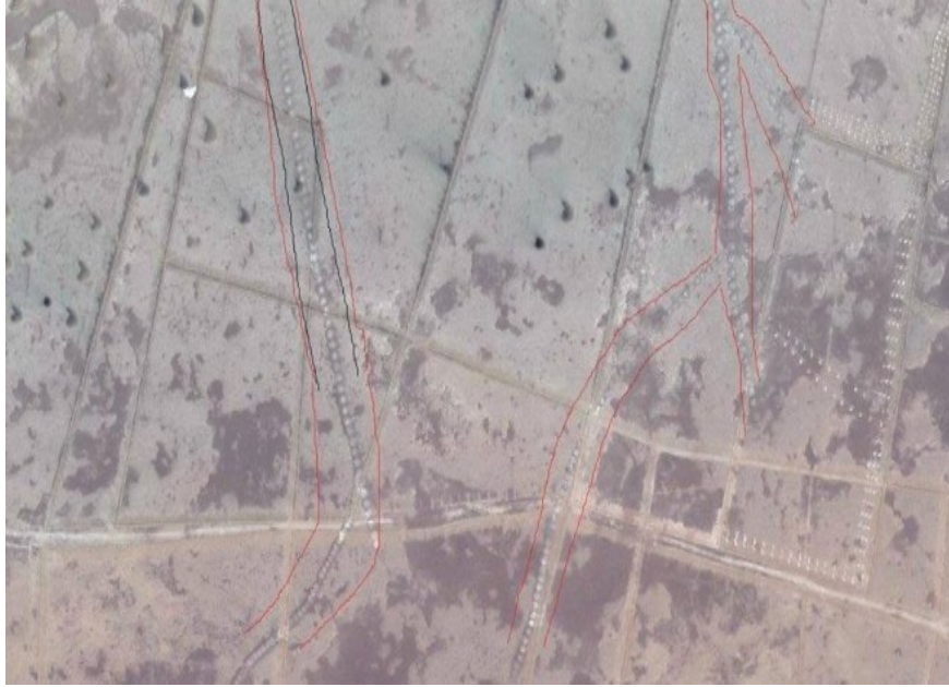
شكل (9) نظام فقارات ودان مهددة بزحف الرمال، واقترب المزارع الحديثة من حدود مواقعها (Google Earth). لاحظ فتحات آبار التنظيف كيف تبدو من الجو متقاربة، وهي المحصورة بين الخطوط الحمراء.
