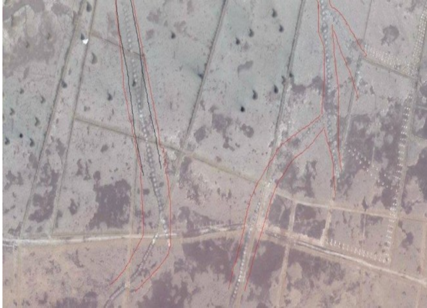
شكل (9) نظام فقارات ودان مهددة بزحف الرمال، واقترب المزارع الحديثة من حدود مواقعها (Google Earth). لاحظ فتحات آبار التنظيف كيف تبدو من الجو متقاربة، وهي المحصورة بين الخطوط الحمراء.
